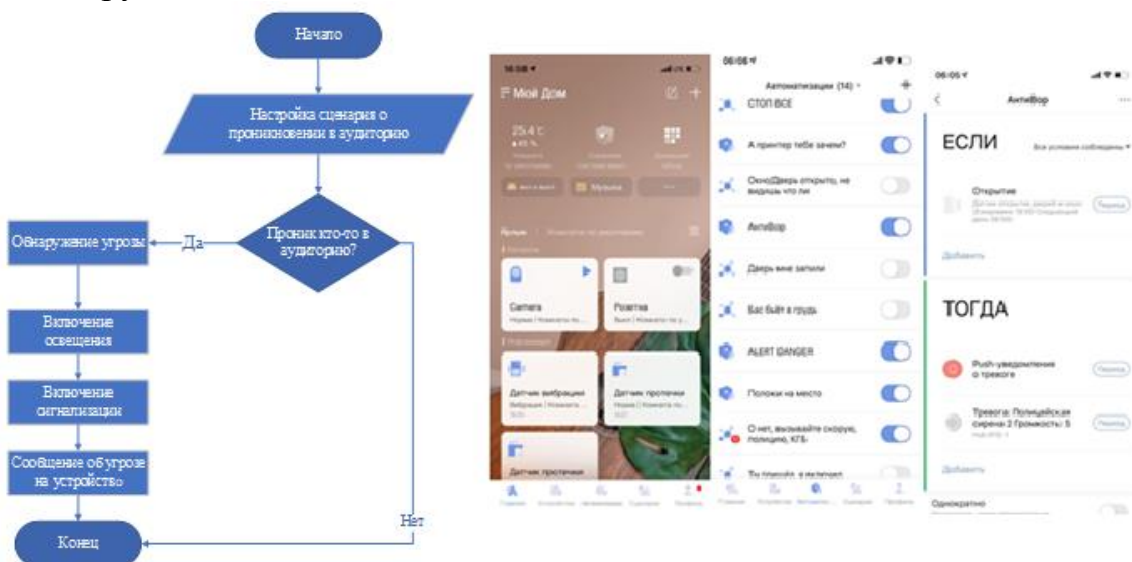
Рисунок 3 – Сценарий о несанкционированном проникновении и его реализация с помощью многофункционального программного средства Aqara
