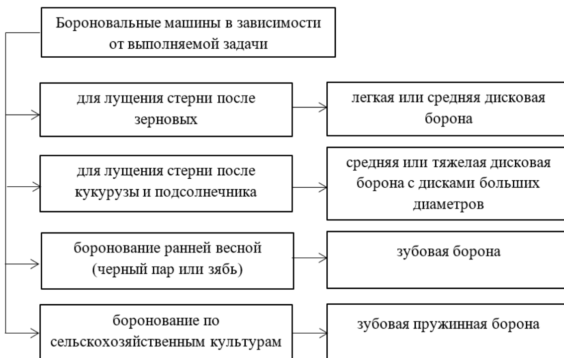
Рисунок 5 – Подбор бороны в зависимости от выполняемой полевой задачи
