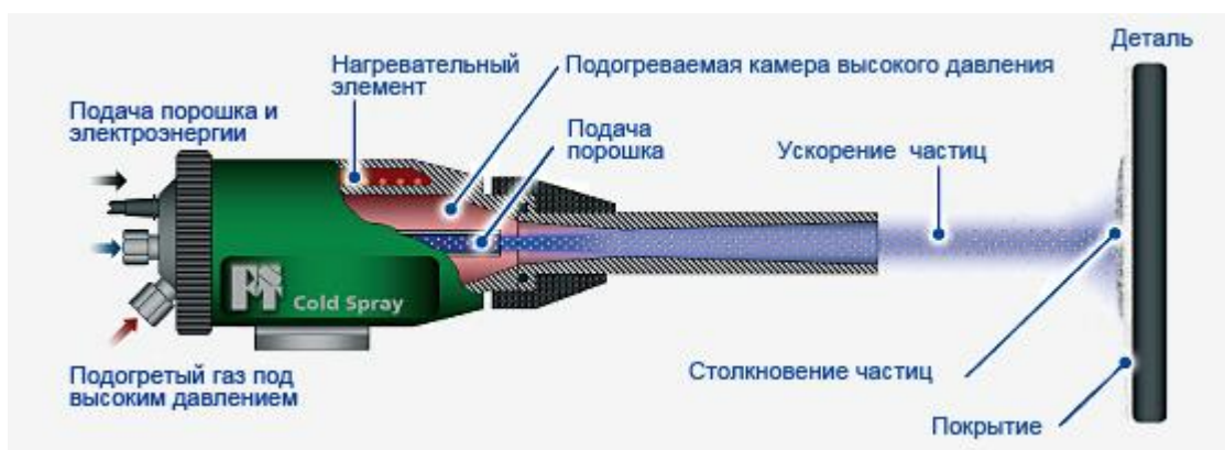
Рисунок 1 – Принцип газодинамического напыления
